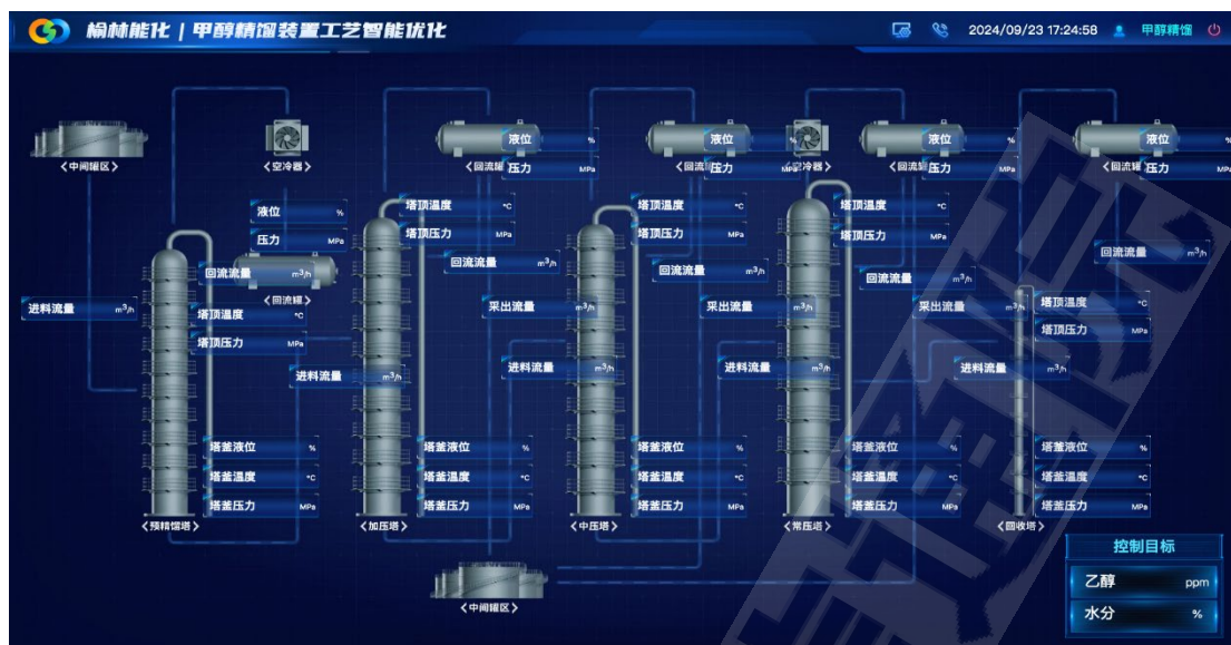
图 10 甲醇精馏装置（五塔三效）工艺智能优化
