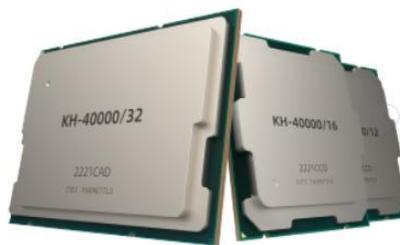
KH-40000采用“永丰”自主内核微架构, 支持自主互连技术ZPI 3.0, 单颗处理器集成最高32核心, 具备64MB高速缓存, 支持8通道DDR4内存, 提供多达128 Lane PCIe通道, 以及SATA、USB等主流IO接口, 支持片上互连和多路互连, 可构建64核服务器整机系统, 以更好满足服务器应用对多核心、多内存、多PCIe扩展等AI需求。
