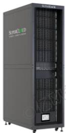
液冷整机柜服务器：基于超云全自研液冷技术，采用先进的冷板式液冷技术，集中散热设计模式，高密度节点部署。机架式和柜式CDU覆盖10-200KW，液冷覆盖整机柜80%散热量。
